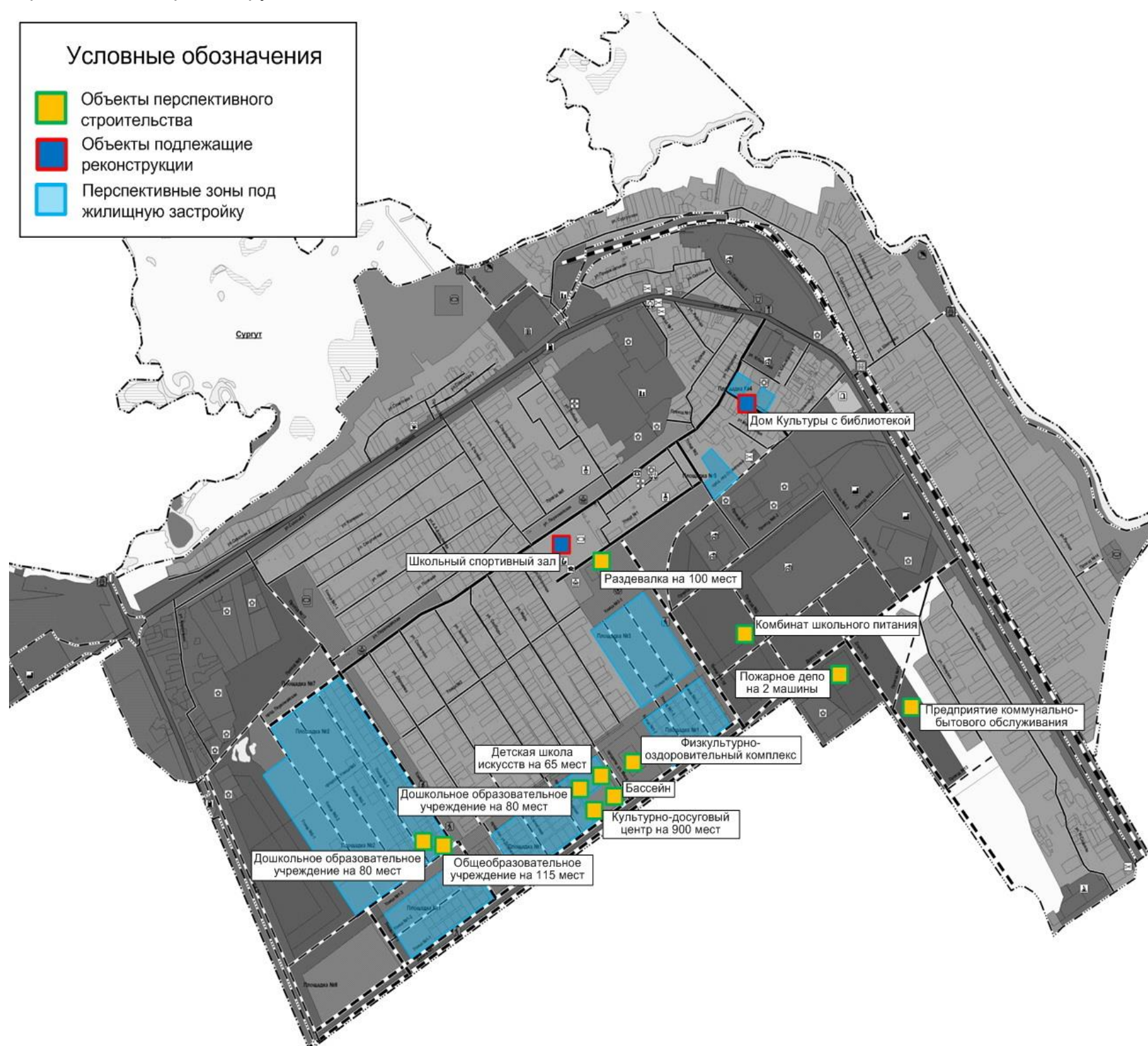
Рисунок 2.2.1 – Территория п. Сургут с площадками под жилую зону и выделенными объектами перспективного строительства и реконструкции
