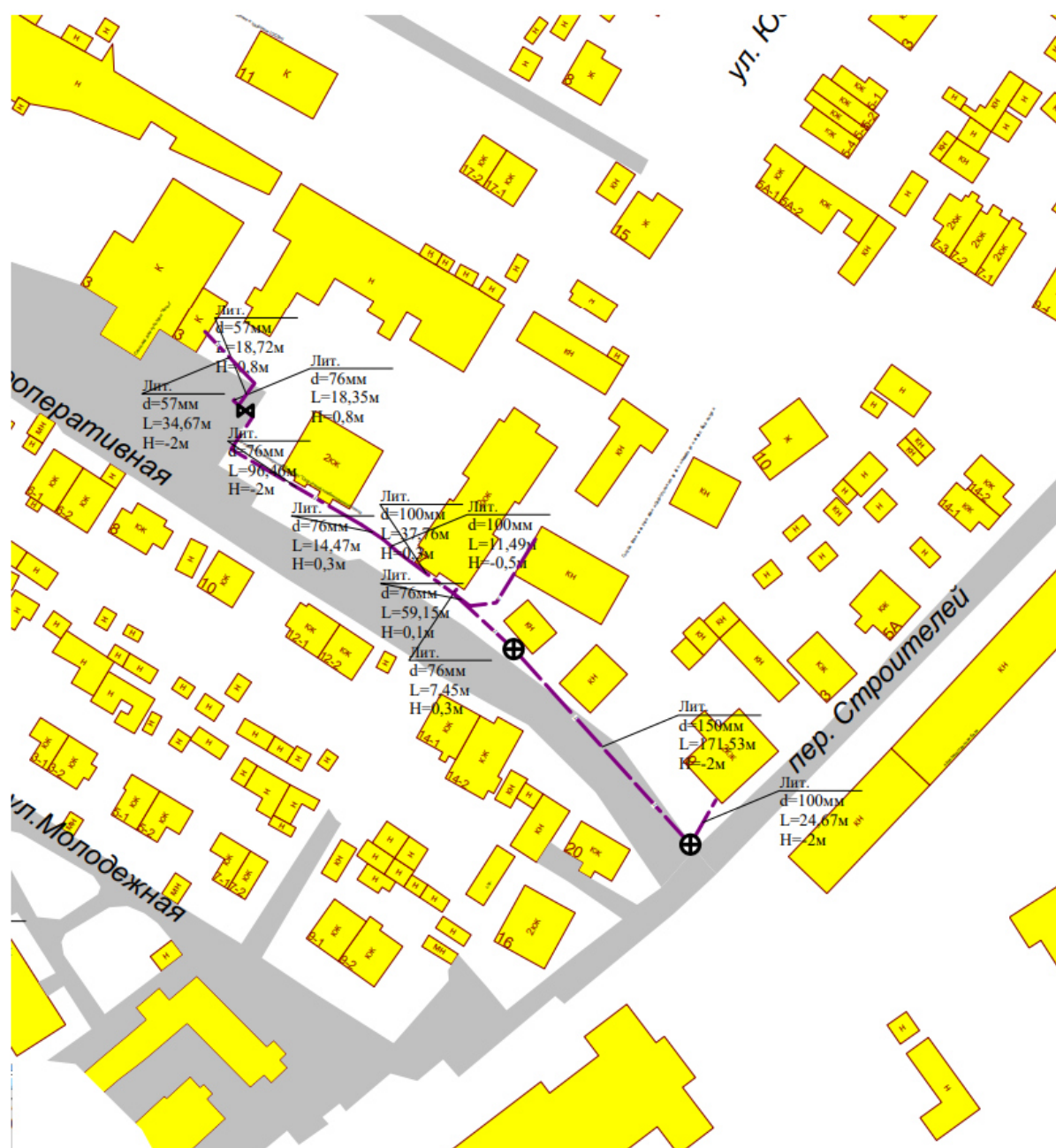
Рисунок 1.3.2.1 - Схема расположения тепловой сети котельной СДК п. Сургут, ул. Кооперативная, 3
