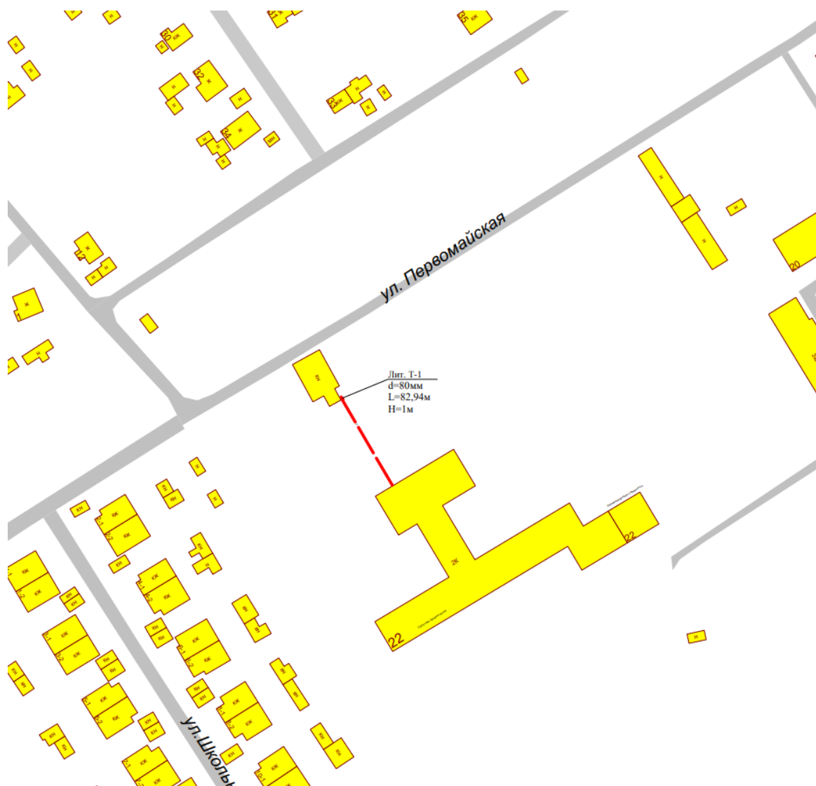
Рисунок 1.3.2.4 - Схема расположения тепловой сети котельной СОШ п. Сургут, ул. Первомайская, 22
